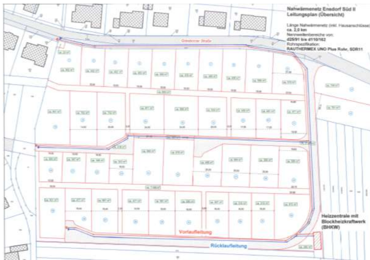
Plan du site Ensdorf Süd II avec le réseau de chauffage © GWBS
